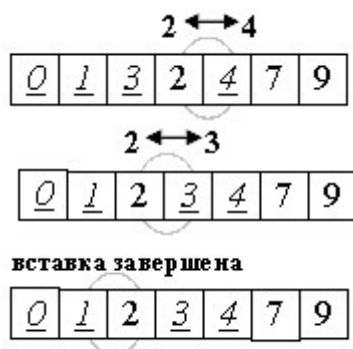
Рис.10. Схема вставки элемента массива на «нужное» место
