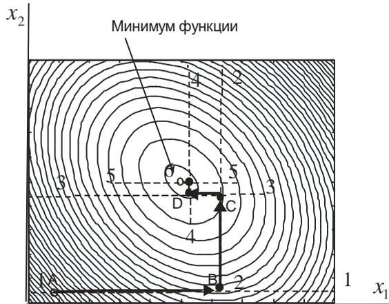
Рис.4.17. Поиск минимума двумерной функции методом поординатного спуска.
