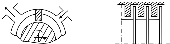
Р и с. 2.28. Конструкция молекулярного насоса
