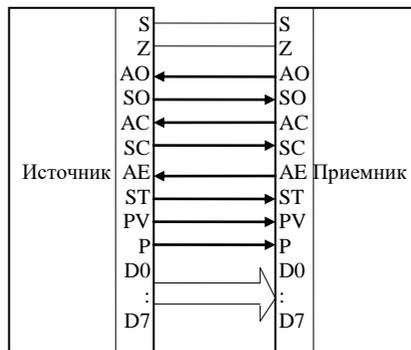
Рис. 6.2. Структура связей между источником и приемником сообщений
