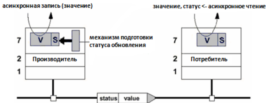
Рис.4.20. Асинхронный механизм обновления
